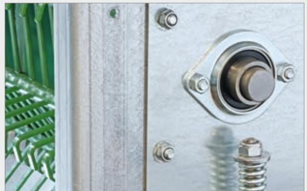
Flanschlager im Stahlblechgehäuse in einem Eierelevator
